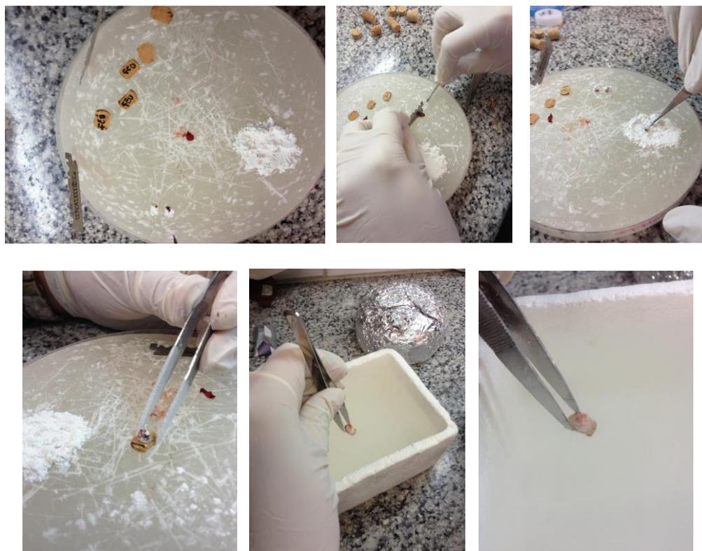
**Figura 4** - Processos de fixação em rolha de cortiça e congelação em nitrogênio líquido.
