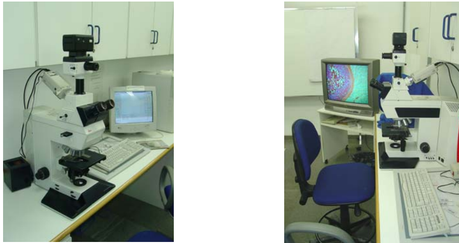
Figura 4 – Sistema de análise digital da imagem, composto por: (a) microscópio equipado com câmera de vídeo; e (b) acoplado a um monitor e a um computador com programa de análise de imagens.
