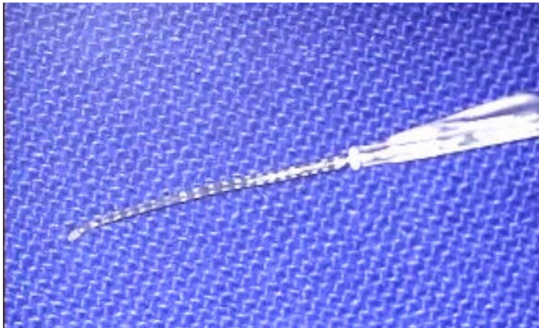
Figura 3 - Feixe de eletrodos intracocleares contendo 22 eletrodos ativos de platina de meia banda distribuídos em 16 mm de extensão
