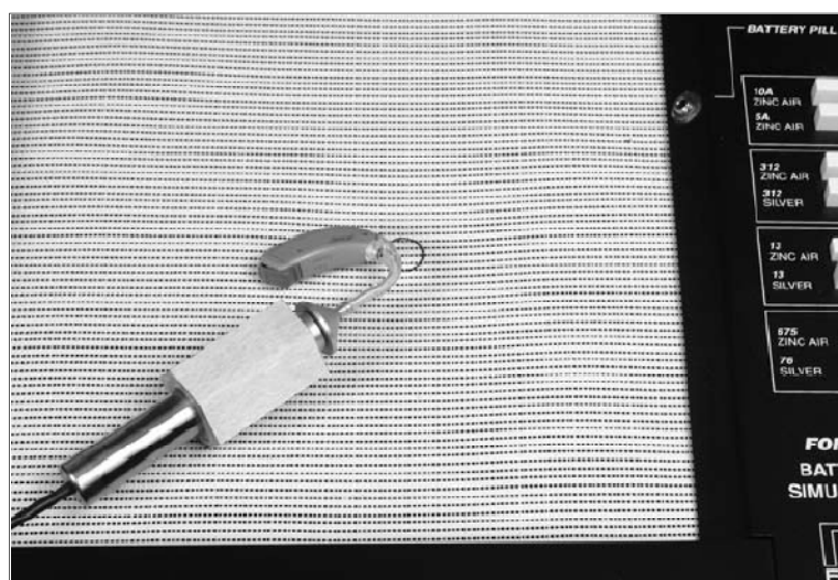
Figura 23- Posicionamento de um BTE na câmara de testes [Fonte: Fonix®7000 (Frye Electronics, Inc., 2008) Hearing aid test system user's manual - Cortesia da Frye Electronics, Inc.]
