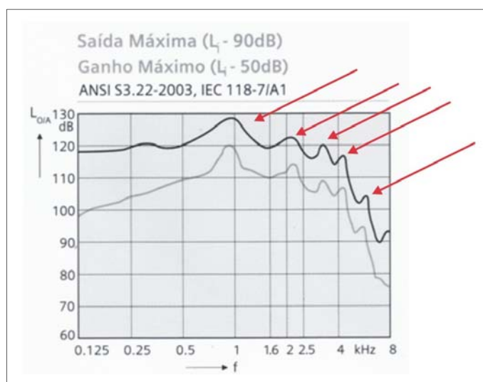
Figura 24 - Curvas de resposta em frequência do modelo ACS85 HPG™, Beltone [Fonte: Prospecto Técnico 15877510-POR-06.08 ver.A, Beltone]
