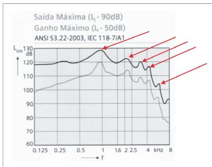
Figura 26 - Curvas de resposta em frequência do modelo Intuis SP™, Siemens [Fonte: Prospecto Técnico em português, sem referência, Siemens]
