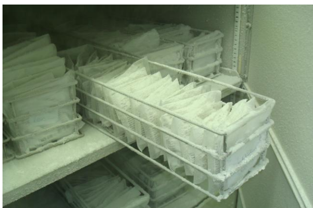
Figura 20: Criopreservação dos tecidos a -80\text{ }^{\circ}\text{C} em gavetas individualizadas por lote. Embalagem de plástico coextrusado de polietileno e nylon validado para esta finalidade.
