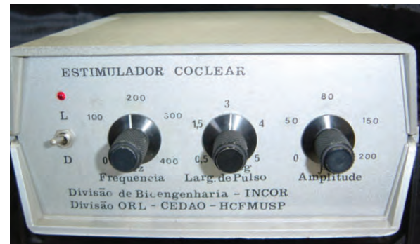
Estimulador coclear desenvolvido pela ORL-Bioengenharia INCOR. Cochlear Stimulator developed by ENT-INCOR Bio-engineering.
