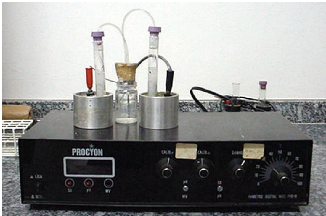
FIGURA 9 - VOLTÍMETRO PARA MEDIDA DA DIFERENÇA DE POTENCIAL TRANSEPITELIAL (DPT) NO PALATO ISOLADO DE RÃ.
