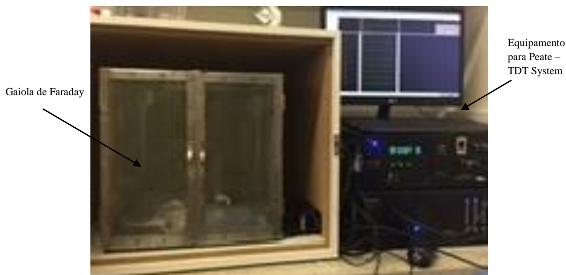
Figura 6. Cabine de atenuação do som e blindagem elétrica (Gaiola de Faraday)
