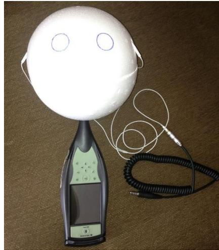
**Figura 6** – Teste dos cabos com adaptador para o sistema de conexão direta entre o implante e a aeronave. Microfone do decibelímetro no interior de uma bola oca de isopor com dois orifícios que simulam uma cabeça com as orelhas onde foram posicionados fones de ouvido do tipo *plug*.
