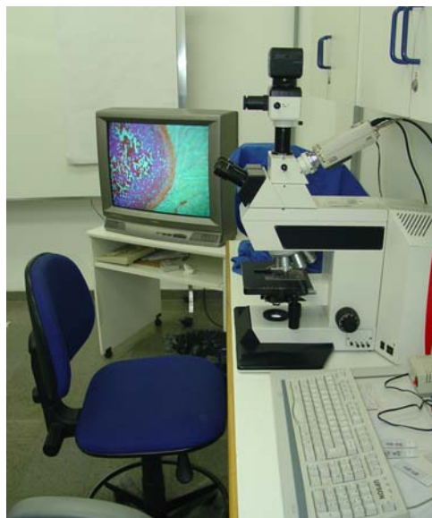
Figura 3: Microscópio acoplado a monitor e computador, no Laboratório de Análise de Imagens e Morfometria da FMUSP (LIM 05).
